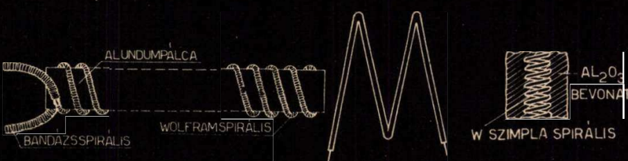
6) ábra. Alundumpálcára tekereselt Wolfram bifiláris spirális alsó bandázsspirálissal. 7) ábra. Neágy ágú szimplaspirális fűtőtest.
