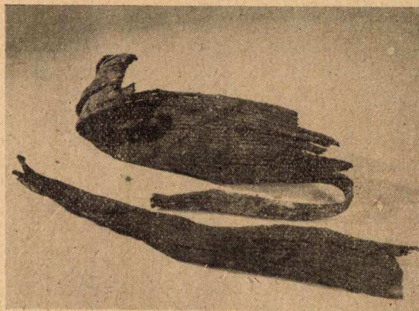
2. ábra. Az I. vonal páncélzatról lefejtett ép állapotban megmaradt jutafonal rétege
