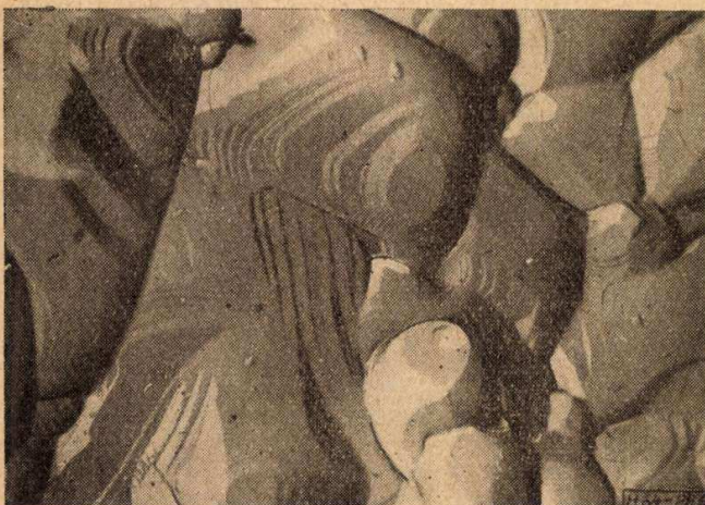
6. ábra. M 1100 jelű anyag elektronmikroszkópia töretfelvétele. 10800 x-os nagyítás. A felvételt az MTA Műszaki Fizikai Kutató Intézet Mikromorfológiai O. készítette.
