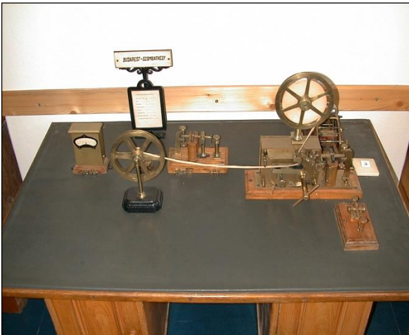
Tájéoló; motolla az írott szalag felcsévéléshez(kézzel hajtvja); mögötte egy táblázat; mellette a jelfogó; az írógép; előtte egy egyszerű billentyű
