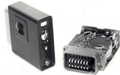
2. kép Pályatelefon és szerkezeti felépítése [L]
