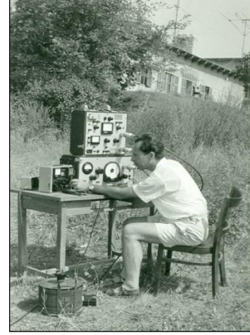
5. kép Térerőmérés a Széchenyi hegyen
