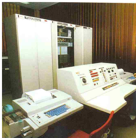
1. kép A táv gépiróközpont felügyeleti munkahelye és háttérben a szekrények
