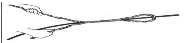
18. ábra A feszítő spirál felszerelése [Teac]
