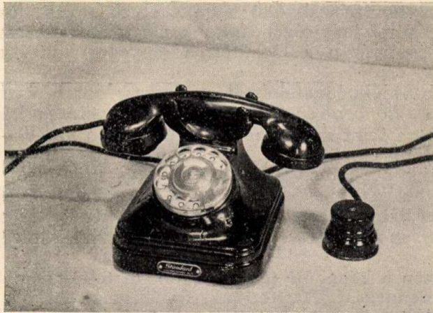
20. ábra. Közöstelepű távbeszélő asztali készülék, minden tartozéka egyetlen bakelit házban elhelyezve.
