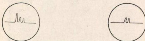
12/a. és b. ábrák. „Íránymérés éjjeli hatás esetén „impuls” rendszerrel..
