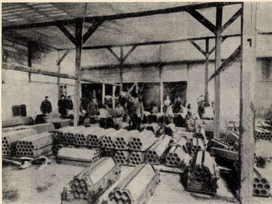
10. áb a. Különböző típusú kábeltömbcsatornák.
