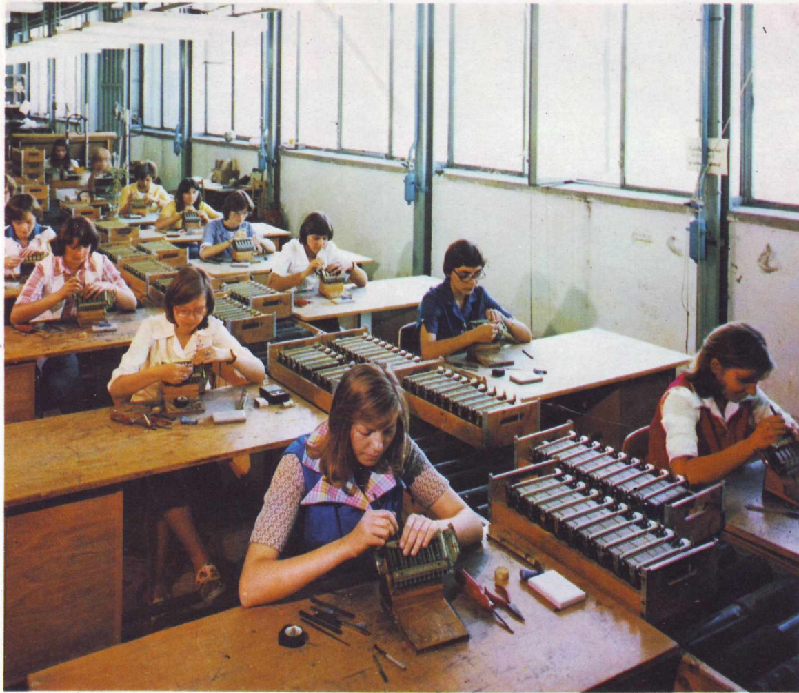
Kapcsológép szerelő sor Assembly line of switching machine Montierungsreihe des Koordinatenschalters Линия сборки МКС
