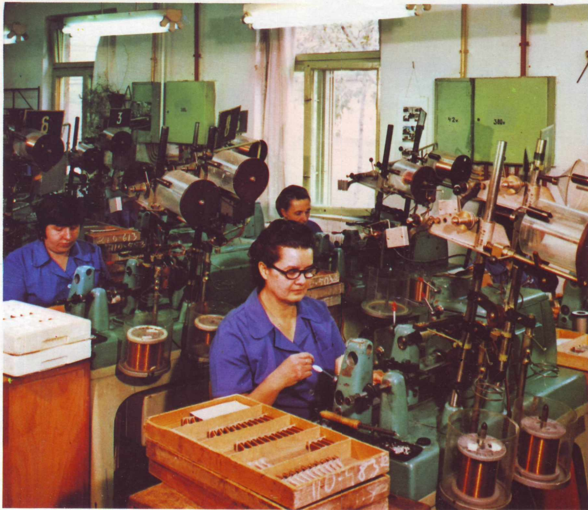
„Micafil” tekercselő automaták “Micafil” automatic coiling machines „Micafil” Wicklungsautomaten Автоматические намоточные машины типа “Минафил”.
