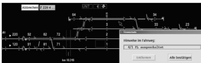
3. ábra: Kezelési biztonság a vágányutak kijelölésével és utaló szövegekkel
