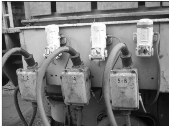
Leállított mozdonyról táplált 1500 V-os hálózat
