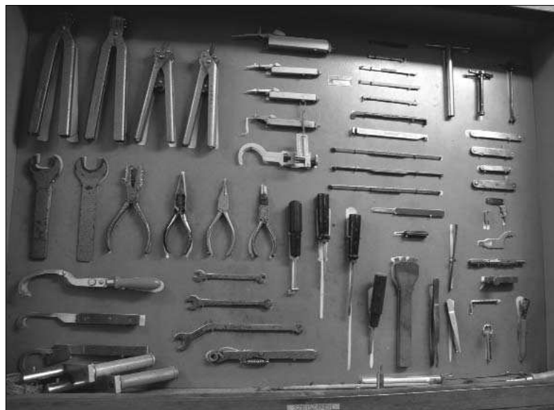
17. ábra: Az alközpontok karbantartásához szükséges speciális kézi-szerszámok
